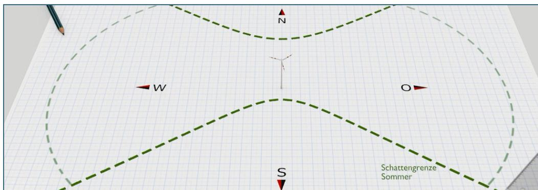
Die Bewegung der Rotoren von Windkraftanlagen (WKA) führt zu einem bewegten Schattenwurf, der mit dem Sonnenstand wandert. Der Schattenwurf tritt nur bei klarem Himmel und damit direktem Sonnenschein auf – der bewegte Schattenwurf nur dann, wenn sich zusätzlich die Rotoren drehen, also Wind weht. Dieser Schattenwurf kann Anwohner einer Windkraftanlage belästigen.
