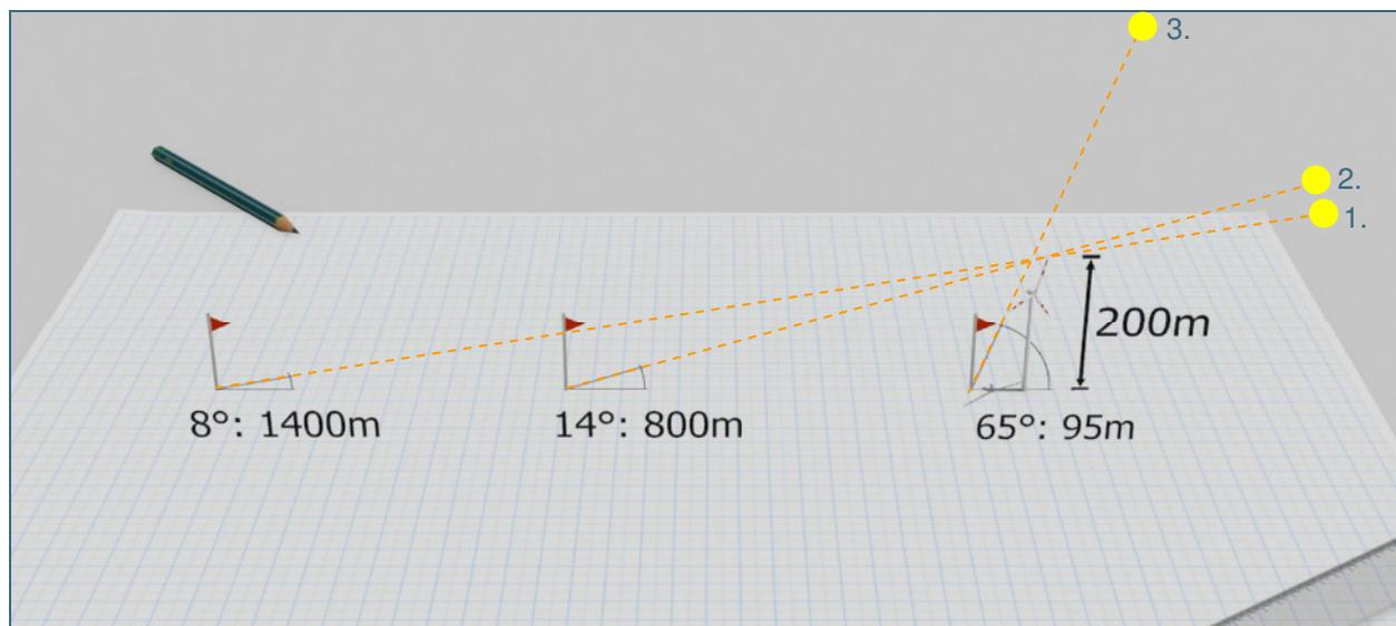
1. **Morgens** nach dem Sonnenaufgang und **abends** vor Sonnenuntergang steht die Sonne flach über dem Horizont und wirft bei großen Windkraftanlagen (hier 200 m) einen **langen Schatten** bis ca. 1.400 m Entfernung. Der Schatten wird mit zunehmendem Abstand von der Windkraftanlage schwächer.
